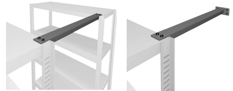
Arriostramientos entre estanterías y a pared
